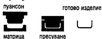
Фиг. 3. Схема на преса за горещо пресуване
